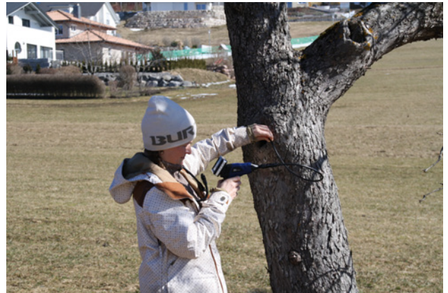
Abb. 7: Endoskopkamera Findoo ProfiLine Plus (andwärts) im Einsatz.
