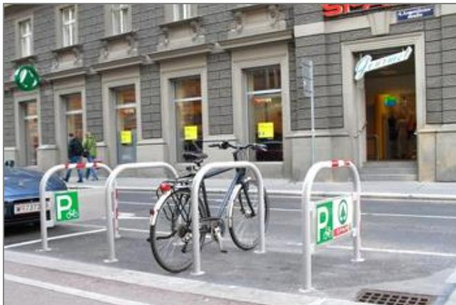
Abbildung 4: mögliche Ausführung nicht überdachte Abstellanlage mit Anlehnbügel
