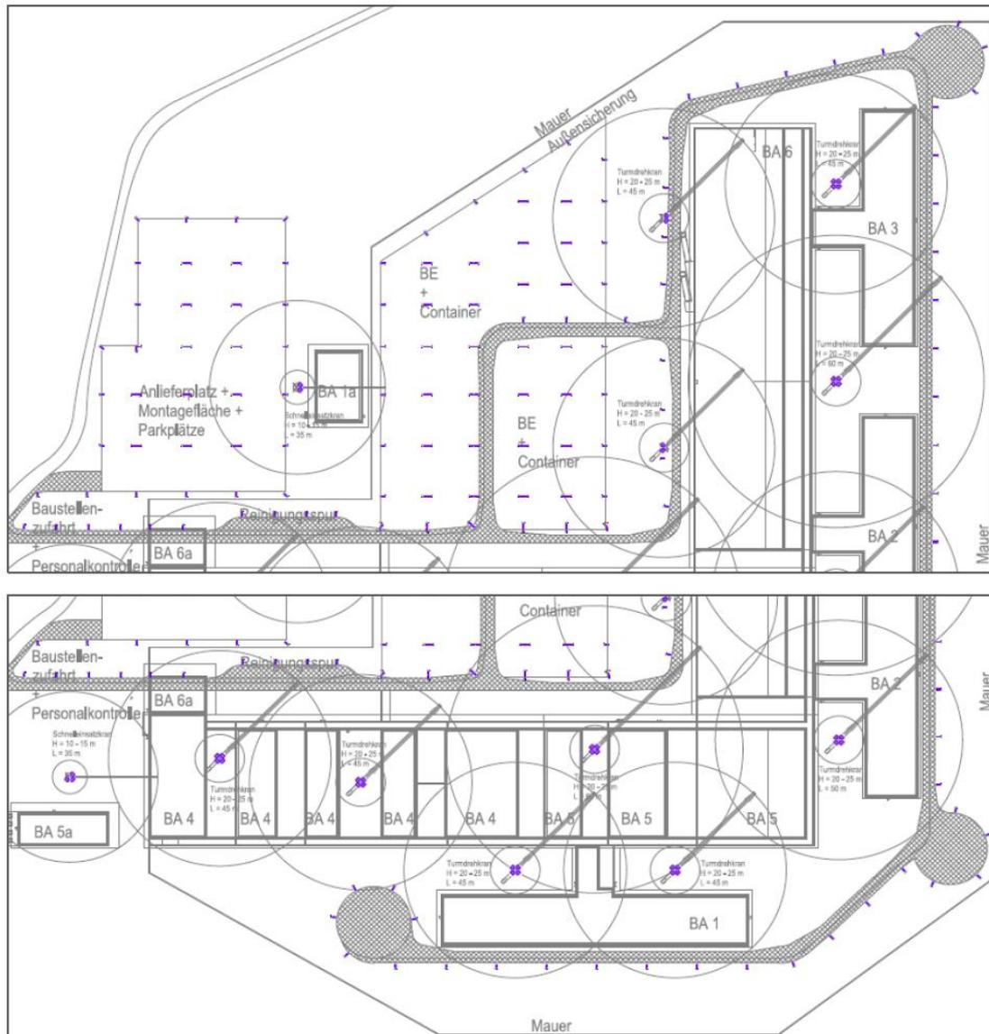
Abbildung 1: Beleuchtungskonzept der JVA „Rottweil - Esch“, Bauphase, unmaßstäblich
