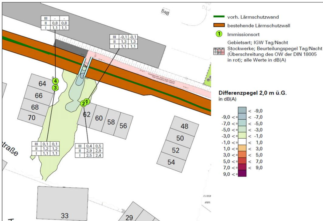
Differenzpegel und -lärmkarte ohne / mit Fußweg durch die bestehende Wall-Wand-Kombination
